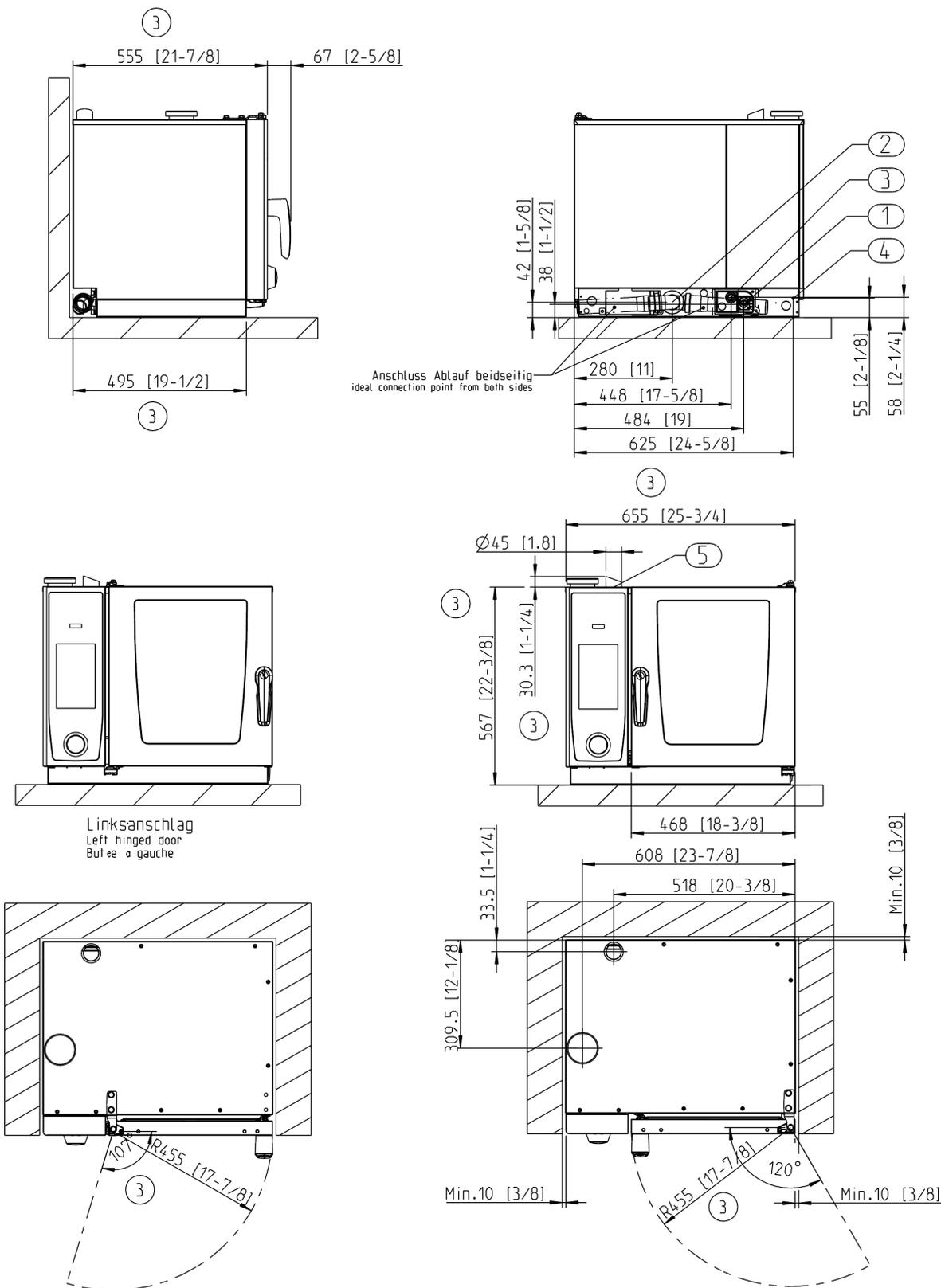
1. Alimentation commune en eau (eau froide) 2. Raccordement électrique 3. Liaison équipotentielle 4. Tuyau de ventilation 2 3/8" / 60mm 5. Écart minimum 2" / 50 mm Pour pouvoir effectuer sans difficulté les travaux de service, nous recommandons un écart de 20" / 500 mm du côté gauche de l'appareil Mesures en mm (pouces)
